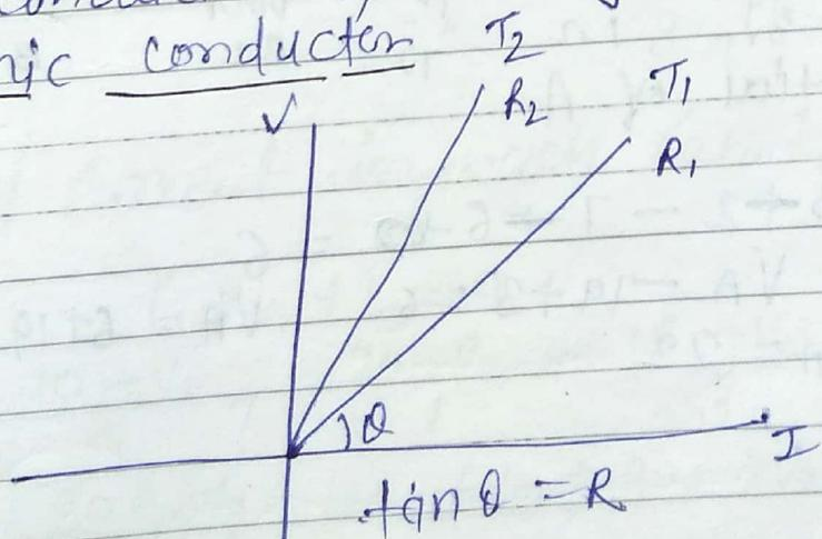
$$\begin{cases} R_2 > R_1 \\ T_2 > T_1 \end{cases}$$
